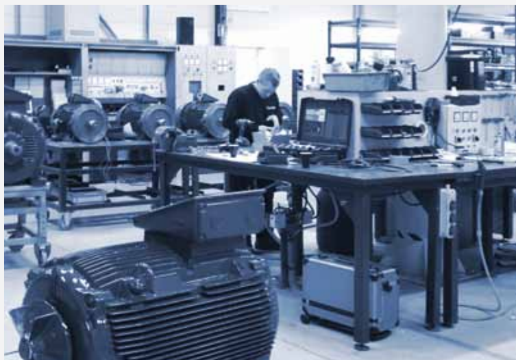
De "speed lijn" bestaat uit een werkeiland waaraan enkele stuks, grote aandrijvingen en spoedopdrachten kunnen worden verwerkt.
